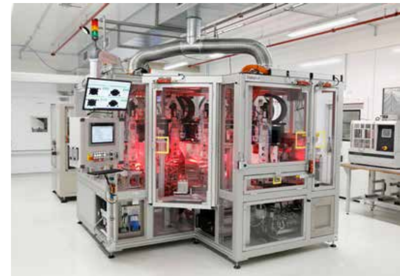
Ein Automat stapelt Elektroden-Sheets automatisch übereinander
