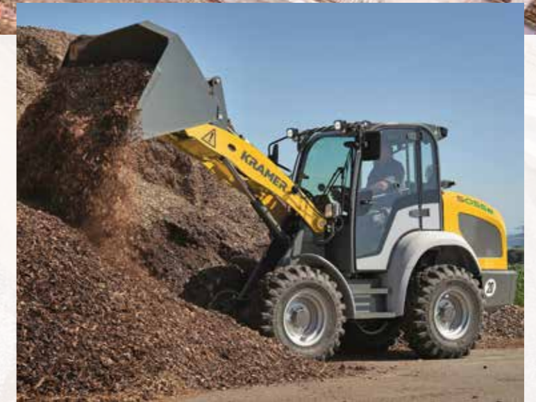
Der Kramer 5055e ist ein vollelektrischer, vierradgelenkter Radlader. Die Akkuladung reicht für eine Tagesschicht
